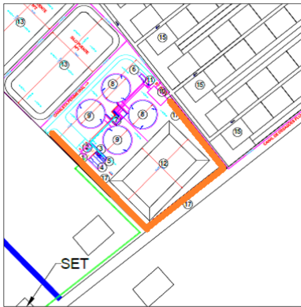
Figura 61: distribución del talud de contención del digestato líquido.
