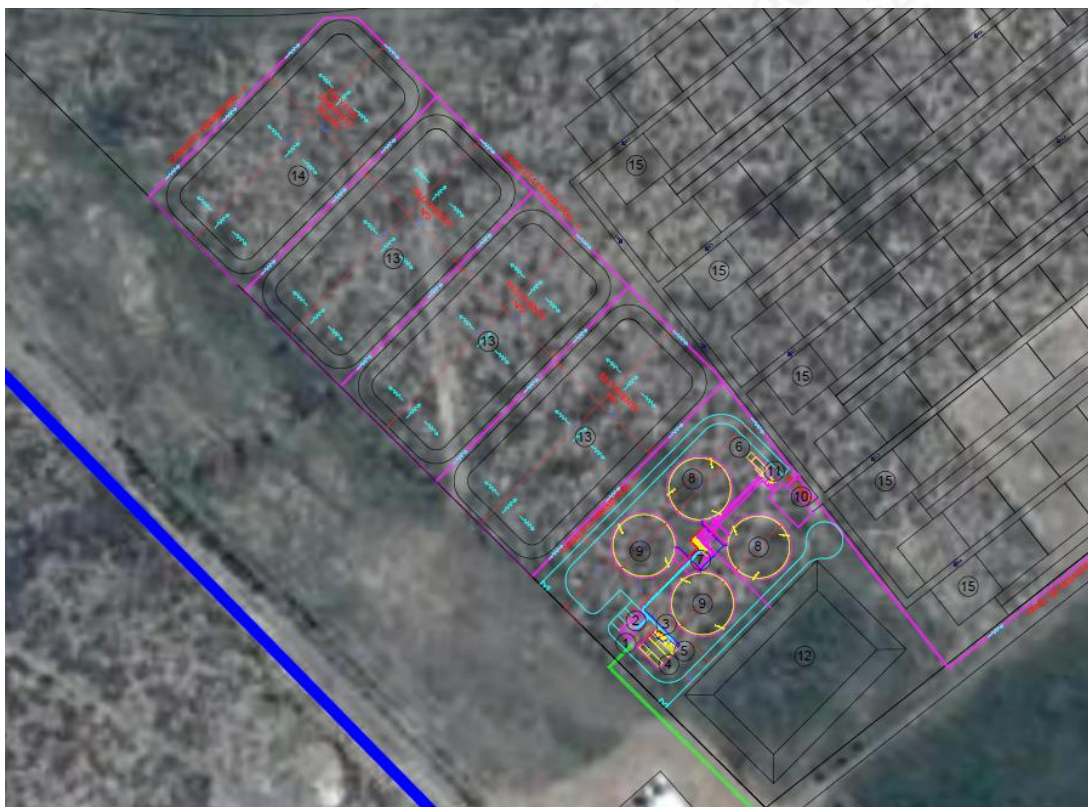
Figura 51: La imagen muestra un detalle de la figura 3 del anexo donde se puede observar la ubicación de la laguna para el digestato líquido (12) y de los sitios de acopio de maíz (13) y digestato sólido (14).
