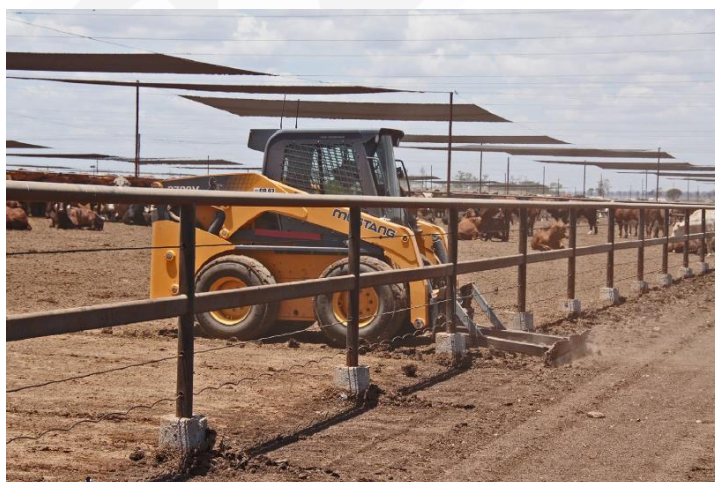
Figura 43: pala minicargadora similar a la que se utilizará para limpiar los corrales
